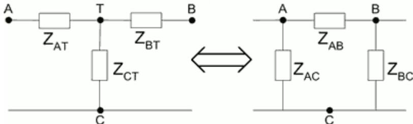
$$Z_{AB} = \frac{Z_{AT} \cdot Z_{BT} + Z_{BT} \cdot Z_{CT} + Z_{CT} \cdot Z_{AT}}{Z_{CT}}$$
